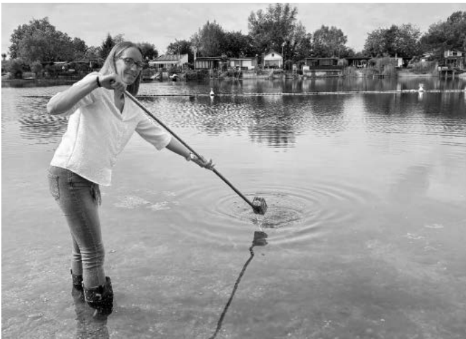
Bildinformationen (Quelle: Landratsamt Rhein-Neckar-Kreis) Elisabeth Rudolf vom Gesundheitsamt des Rhein-Neckar-Kreises entnimmt am Hohwiesensee in Ketsch eine Wasserprobe. Bis Mitte September kontrolliert das Gesundheitsamt die Wasserqualität der offiziellen Badeseen im Landkreis regelmäßig.
